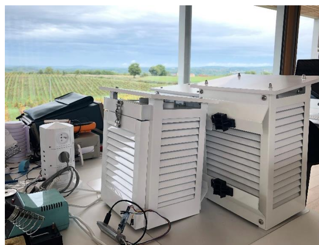
Stations météo avant leur mise en place dans les vignes
